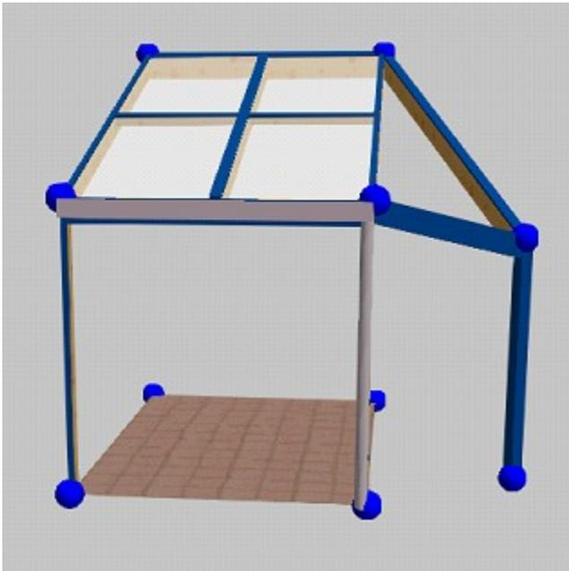
In der Abbildung rechts wird eine Glasfläche als freies Bauteil zwischen 3 Konstruktionspunkten aufgespannt
